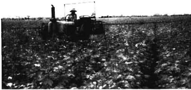
Abb. 3: Schlepper mit „Low volume“-Spritzgerät bei der Behandlung von 90 cm hoher Baumwolle (Nicaragua). Ausbringungsmenge: 50 l/ha
