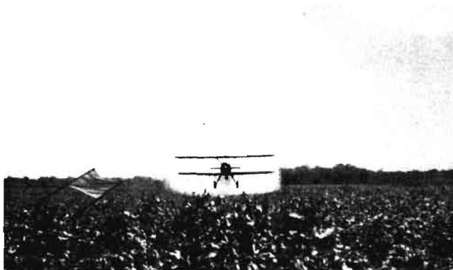
Abb. 8: Spritzflugzeug bei der Behandlung 1,4 m hoher Baumwolle (El Salvador). Links vorn erkennt man den „flagman“.
