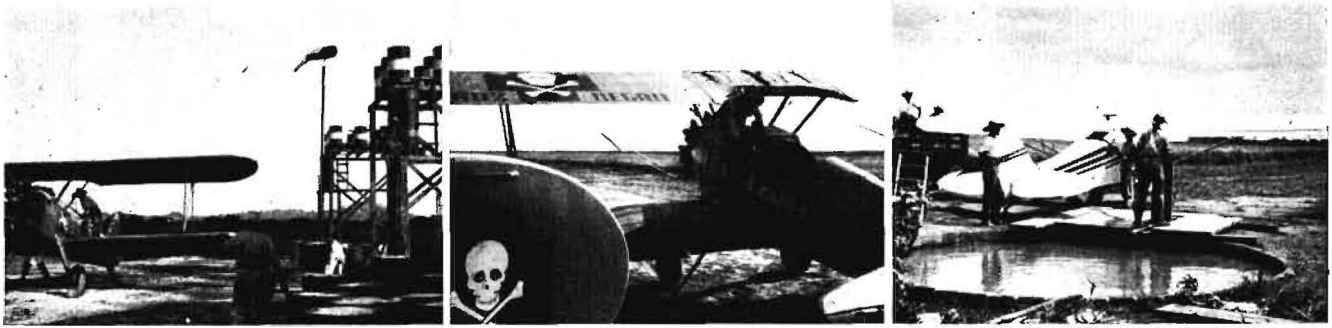
Abb. 10: Füllung eines Spritzflugzeuges (El Salvador). Als Wasservorratsbehälter werden alte Metallfässer benutzt, die durch Rohre miteinander verbunden sind. — Abb. 11: Füllung eines Spritzflugzeuges aus einem Tankwagen (Mexiko). — Abb. 12: Füllung eines Spritzflugzeuges mit einer Handpumpe (Guatemala)
