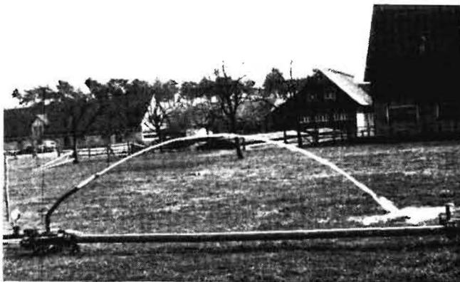
Abb. 8: Strahl aus Düse D 24/60, Betriebsdruck 0,5 atü; Strahlbahn infolge der nur unwesentlichen Auflösung mit der theoretischen Wurflinie gut übereinstimmend (Scheitelpunkt in der Mitte, abfallender Strahlabschnitt spiegelbildlich zum aufsteigenden)
