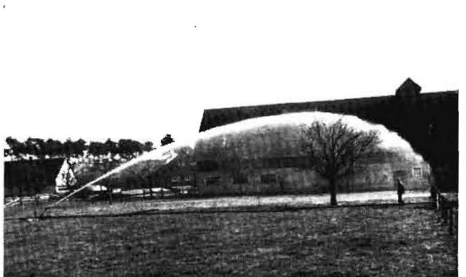
Abb. 9: Düse wie in Abb. 8, Betriebsdruck 3,0 atü; infolge der stärkeren Auflösung tritt die Verkürzung des abfallenden Strahlabschnitts stärker als in Abb. 8 in Erscheinung, das Wurfverhältnis ist wesentlich ungünstiger
