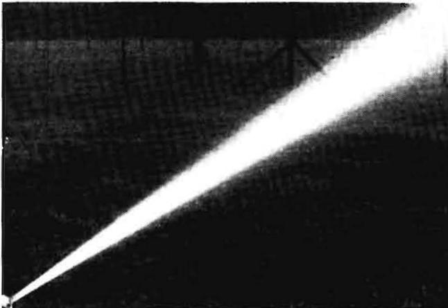
Abb. 6: Strahl aus Düse D 12/60°, Strahlrohrweite 1", kein Gleichrichter, Düsendr. rd. 3 atü, Strahl sehr stark turbulent, Bel.: Tageslicht  $\frac{1}{25}$ . Die Strahlaulösung scheint gleichmäßig kontinuierlich zu erfolgen
