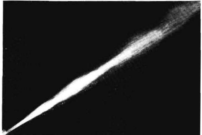
Abb. 7: Strahl wie Abb. 6. Bel.: Elektronenblitz  $\frac{1}{1000}$ . Auflösungsvergang durch rasche Folge von Ablösungswirbeln ist an der Knotenbildung zu erkennen
