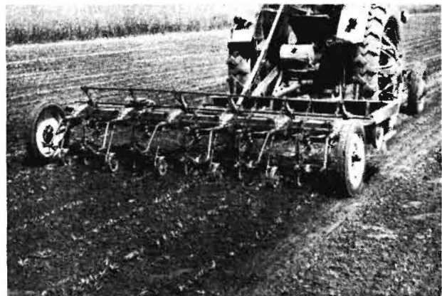
Abb. 3: Ausdünnern mit hin- u. herpendelnden Messern (Pendelausdünnern)
