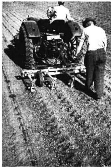
Abb. 2: Arbeitsbild des Pendelausdünners
