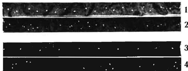
Abb. 11: Die Längsverteilung im Vergleich zwischen pneumatischer Gleichstandsart und normaler Drillsaat bei Weizen
