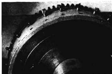
Abb. 3: Die Kornaufnahme an der „Röhrchenwalze“ bei Monogermisamen
