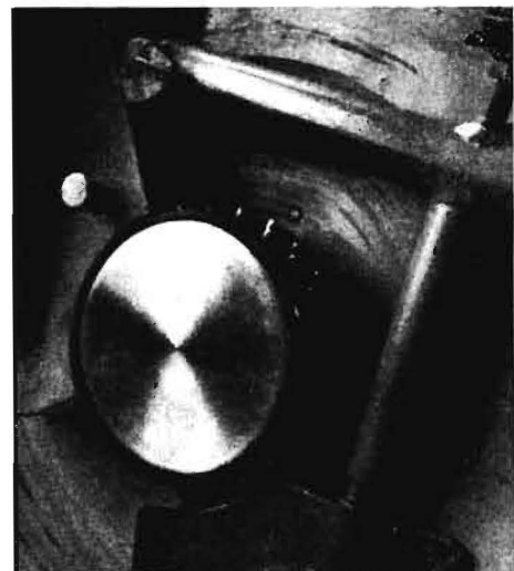
Abb. 15: Die Saugwalze mit einem Düsenband für kleine Kornarten: das Düsenband trägt sehr viele Saugöffnungen in zweireihiger Anordnung für die hier notwendigen kleinen Kornabstände
