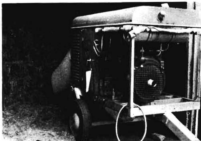
Abb. 4: Das in Silsoe entwickelte Belüftungsaggregat vor einem Stapel Heuballen in einer Scheune
