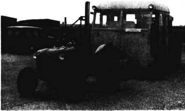
Abb. 1: Der Fordson Dexta vor einem der Bremswagen des englischen Schlepperprüffeldes. Prüfbahn ist die Landebahn eines Flugplatzes in Teer-Makadam-Bauweise
