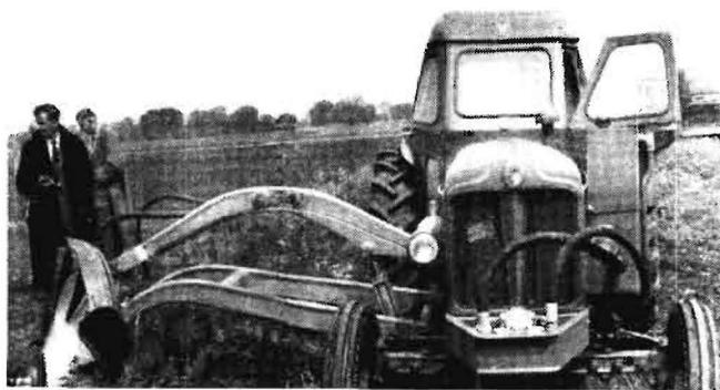
Abb. 3: Frontansicht der Grabenreinigungsräse mit hydraulischem Antrieb der Fräseschelbe
