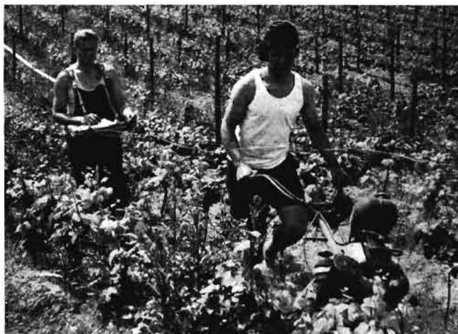
Bild 1: Pulsfrequenzversuch mit Motorhacke und rotierendem Werkzeug
