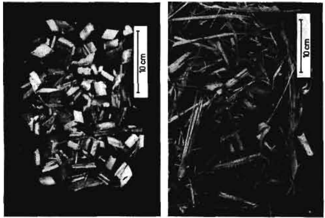
Bild 7: Beschaffenheit des Häcksels beim Ernten von Silomais links mit Trommelhäcksler (theoretische Häcksellänge l_{th} = 19 mm) rechts mit Mähtrömelhäcksler (Fahrtgeschwindigkeit v_f = 0,9 m/s)
