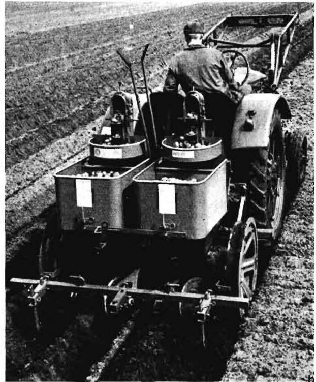
Bild 6: Spurschare an einer Kartoffellegemaschine mit selbsttätiger Einlage
