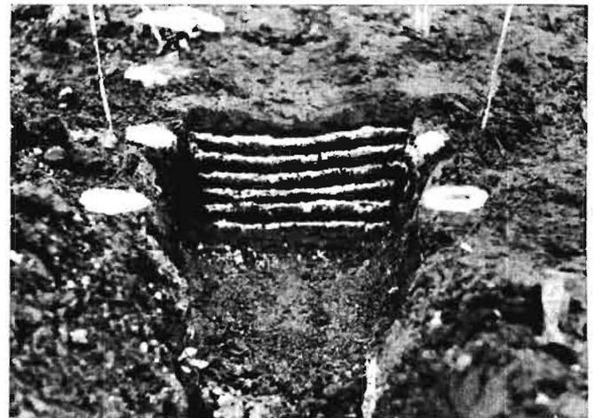
Bild 3: Bodenverformung unter der Spur, mit Kalkschichten sichtbar gemacht
