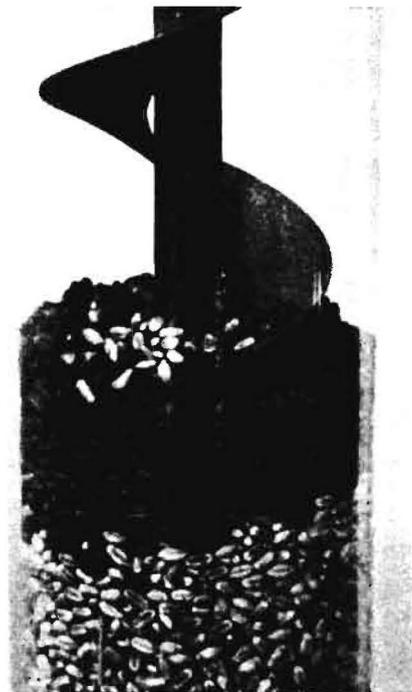
**Bild 9: Demonstration des Fördervorgangs mit gefärbten und ungefärbten Weizenkörnern in einem Glasrohr**
