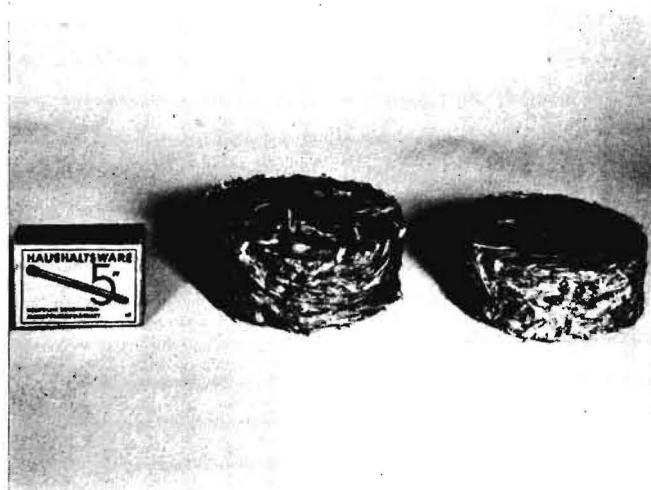
Bild 1: Luzernebriketts. Durchmesser etwa 80 mm, Höhe etwa 35 mm, Dichte etwa 700 kg/m 3 , aufgewendeter Preßdruck etwa 450 kg/cm 2
