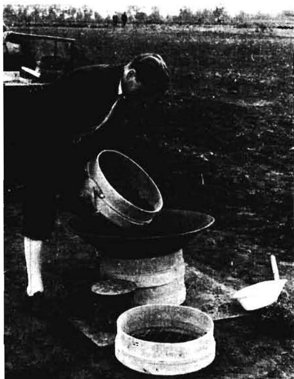
Bild 7: Siebsatz für die Schollenanalyse mit zwei Probezylindern
