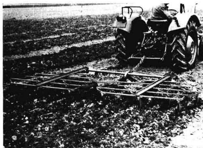
Bild 2: Infolge der einfachen Anhängung pendelnde Grubberegge
