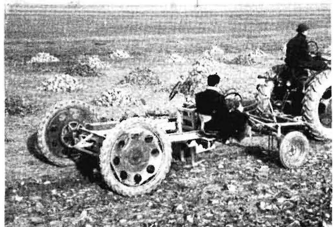
Bild 3: Versuchseinrichtung, mit der die verschiedenen Rodversuche durchgeführt wurden
