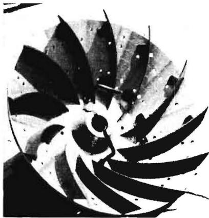
Bild 6: Der Läufer H\*12 M mit zwei Mitnehmer-Werkzeugen (400 mm  $\varnothing$ )
