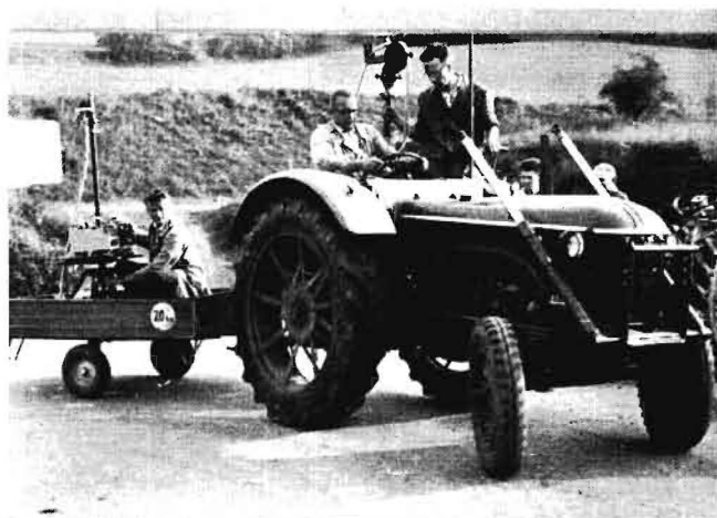
Bild 1: Lenkkraftmessungen in Spiralfahrten auf Betonbahn
