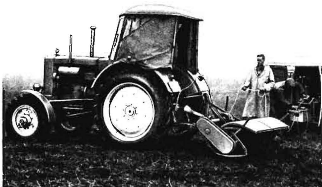
Bild 6: Meßnabe in Verbindung mit motorisiertem Meßwagen
