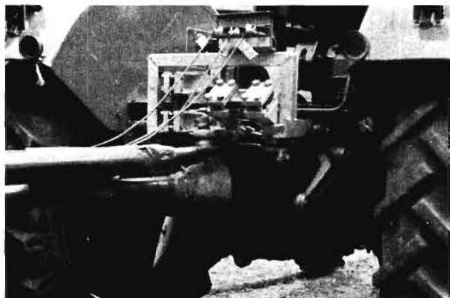
Bild 8: Die Deichselbefestigung unter der Zugschiene
