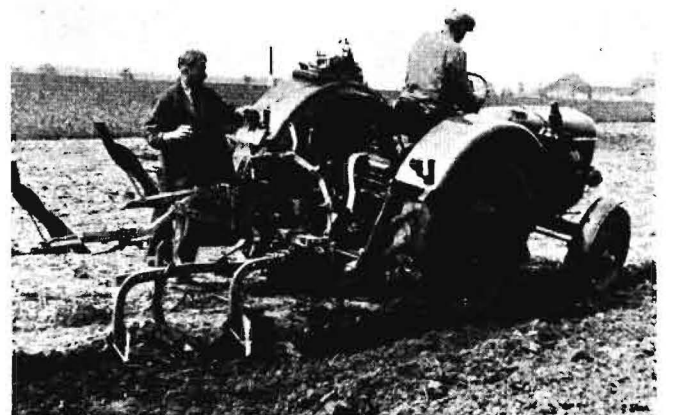
Bild 2: Schlepper und Pflug mit Meßeinrichtung beim Feldversuch
