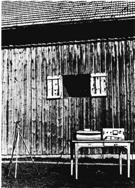
Bild 7: Geräuschmessungen bei einem in einer Holzwand zurückgesetztem Axiallüfter
