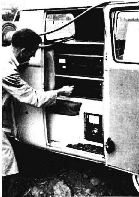
Bild 2: Über den Meßverstärker (im Meßwagen unten) werden die Beschleunigungswerte auf ein Klassiergerät übertragen, das eine statistische Auswertung zuläßt
