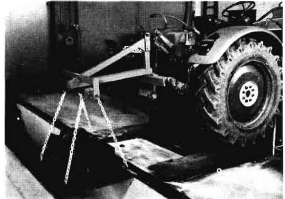
Bild 11: Wanne mit Gewichten am Hebel bei Versuchen zur Klärung der Reibungsverhältnisse
