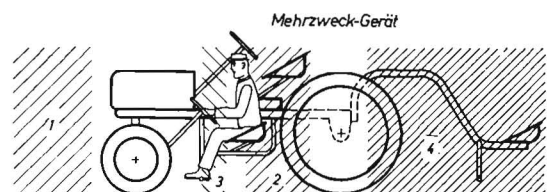
Bild 1: Anbau Räume an Schleppern Schraffurdichte zeigt Wertigkeit des Arbeitsraumes
