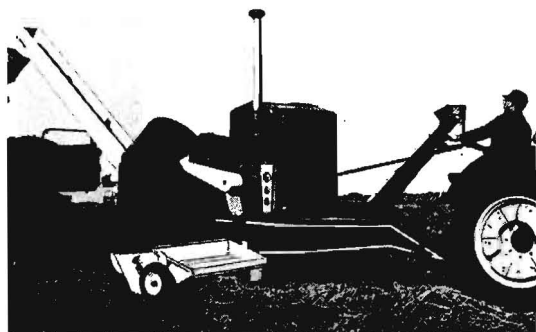
Bild 7: Aufsammel-Brikettierpresse aus dem Jahre 1962
