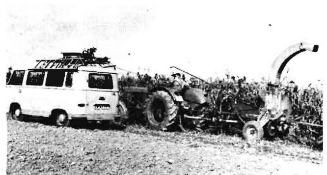
Bild 2: Ermittlung des Betriebsbelastungsspektrums eines Feldhäckslers durch Meßwagen
