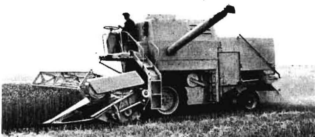
Bild 2: Mäh-drescher, bei dem die Verkleidung als tragendes Element der Konstruktion ausgebildet wurde. Dadurch wurde eine Formgebung erreicht, die technisch richtig ist und von der Form aus gesehen ruhig wirkt
