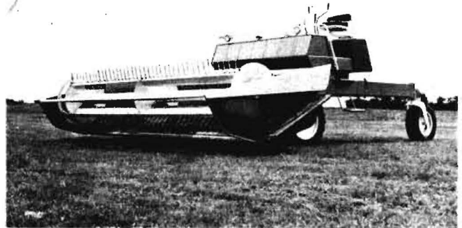
Bild 3: Schwadmäher, dessen Verkleidung tragendes Element der Konstruktion wurde
