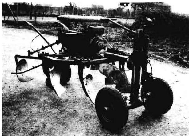
**Bild 5: Stockräumer für den Seilzug mit aufgebautem Antriebsmotor (1,5 PS) für den tastergesteuerten Schwenkmechanismus**
