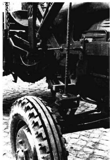
Bild 2: Die Meßeinrichtung zur Bestimmung der Bodenunebenheiten
