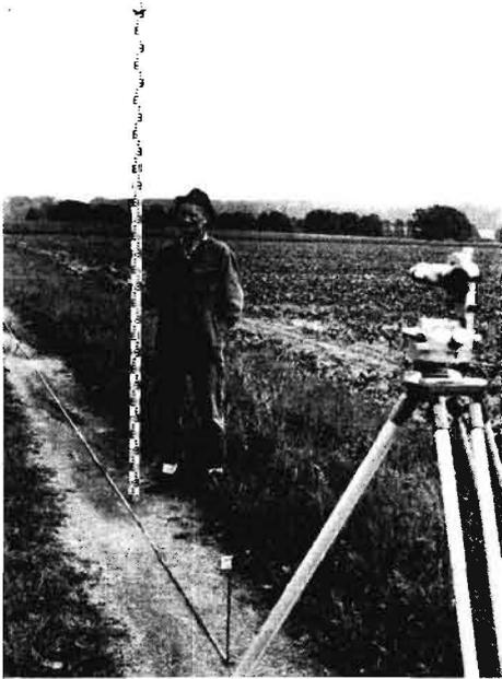
Bild 7: Geodätische Feldwegvermessung mit Theodolit, Meßlatte und Maßband beim Schlepper-Prüffeld
