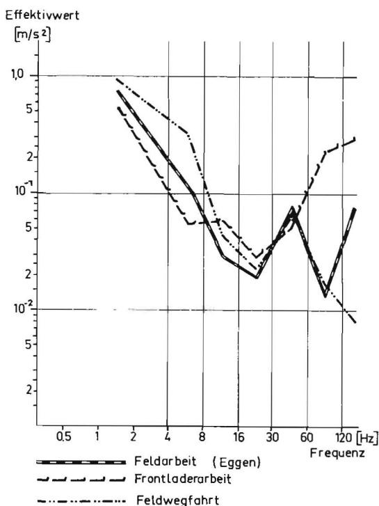
Bild 8: Frequenzspektrum mechanischer Schwingungen zwischen Fahrer und Sitz bei verschiedenen Arbeiten mit Radschlepper D Schwingungsrichtung z
