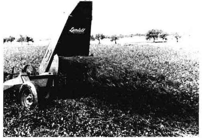
Bild 14: Verwendung eines Schlegelfeldhäckslers mit Schwadablegevorrichtung zum Stengelknicken (Versuchsmaschine D)
