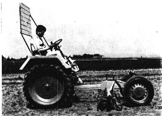
Bild 1: Versuchsschlepper mit völliger Freisicht
