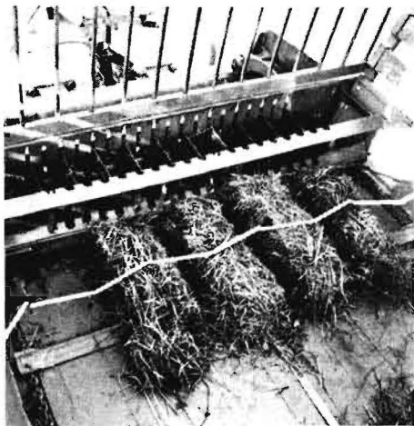
Bild 6: Schneidvorrichtung mit bewegten Messern von Wagen (2) Messerabstand hier 12 cm
