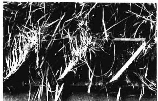
Bild 14: Feingezahnte Schneidkanten setzten sich mit Halmgut zu
