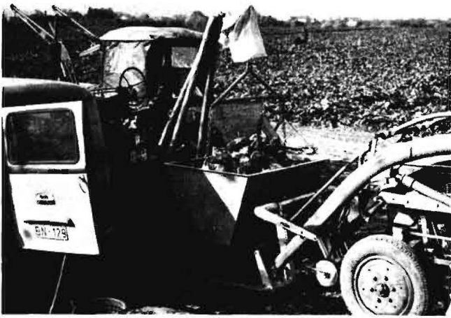
Bild 8: Wiegen der Rüben an der elektronischen Zugwaage
