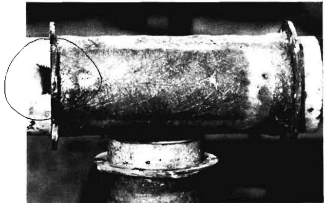
Bild 4: Oberes Förderrohr aus glasfaserverstärktem Polyesterharz (GFK) bei Versuchsende Förderrohr am Auslauf durchgescheuert
