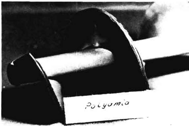
Bild 6: Förderschnecke mit Polyamid-Beschichtung bei Versuchsende 5 Stunden Versuchsdauer
