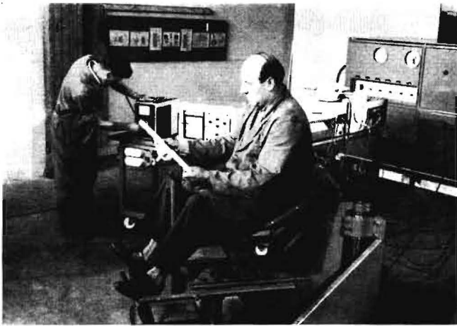
Bild 2: Servo-hydraulisch angetriebener Schwingtisch mit Druck-Erzeuger-anlage und elektronischer Ausrüstung
