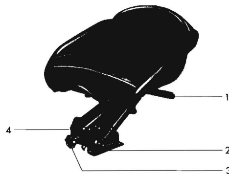
Bild 12: Schleppersitz Nr. 15 mit stufenloser Sitzfeder-Verstellung (3) und Kontrollstift für richtige Gewichtseinstellung (4)
