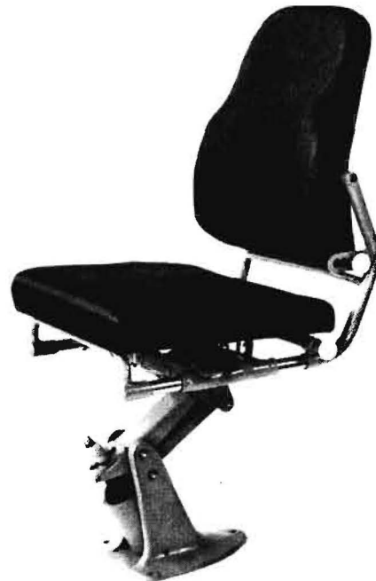
Bild 1: Parallelogrammsitz mit Gewichtsverstellung und Stoßdämpfer, Höhen- und Längs- sowie Rückenlehnenverstellung, der vor mehr als zehn Jahren als Schleppersitz entwickelt wurde und heute große Verbreitung bei Lastkraftwagen und Omnibussen gefunden hat
