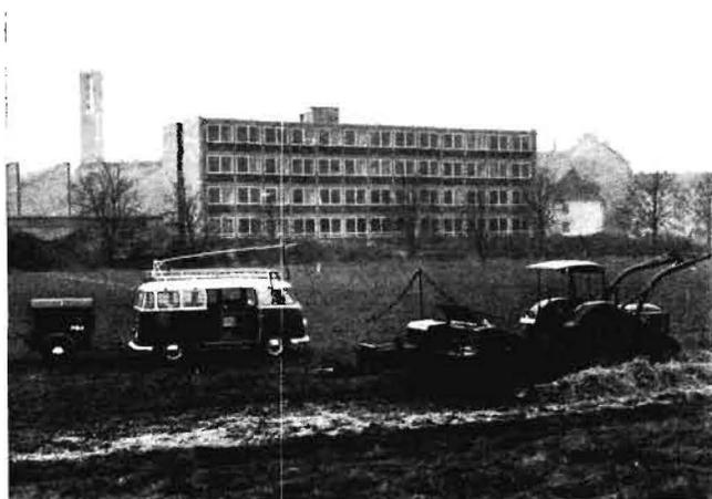
Bild 1: Messen der Beanspruchungen in den Organen einer Hochdruck-Ballenpresse beim Feldeinsatz
