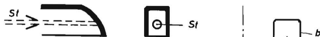
Bild 13: Schaufelform zu den Regnerformen II und II A (Schwinghebel nach oben ausschlagend) Längsschnitt (links); Querschnitt (rechts)
