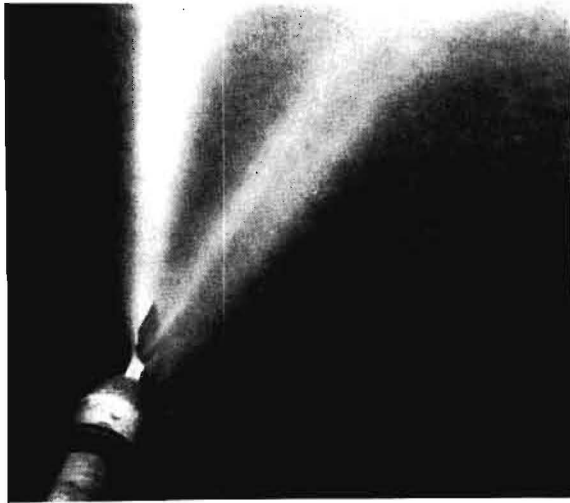
Bild 6: Strahlspaltung durch ein Blech von 1 mm Stärke Es entstehen zwei in Tropfen aufgelöste Strahlteile, umgeben von Wasserstaub
