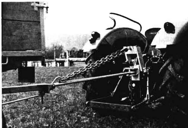
Bild 11: Zugkraftverstärker Streb-o-matic in der Schweiz
