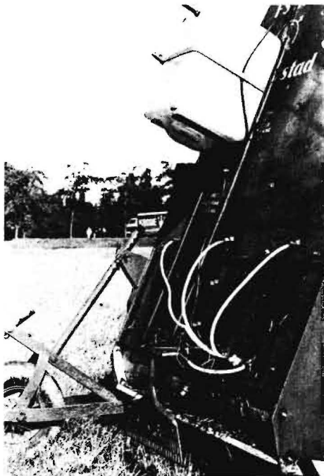
Bild 5: Schlegelfeldhäcksler mit einem Versuchsgerät des LTI-Säurevertellers, das im Jahre 1964 benutzt wurde
