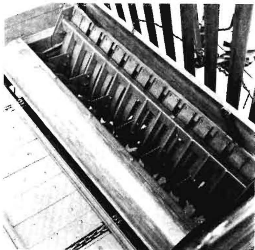
Bild 4: Einteilige Förderschwinde, Schneidvorrichtung mit feststehenden und nicht angetriebenen, rotierenden Messern, System IV
