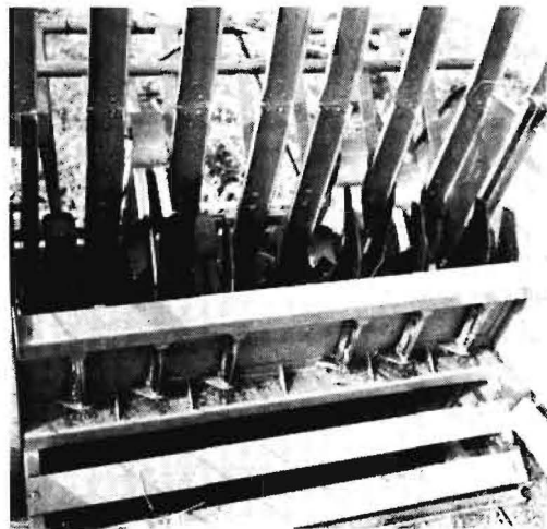
Bild 7: 6-teilige, lange Schubstange, Schneidvorrichtung mit feststehenden Messern
