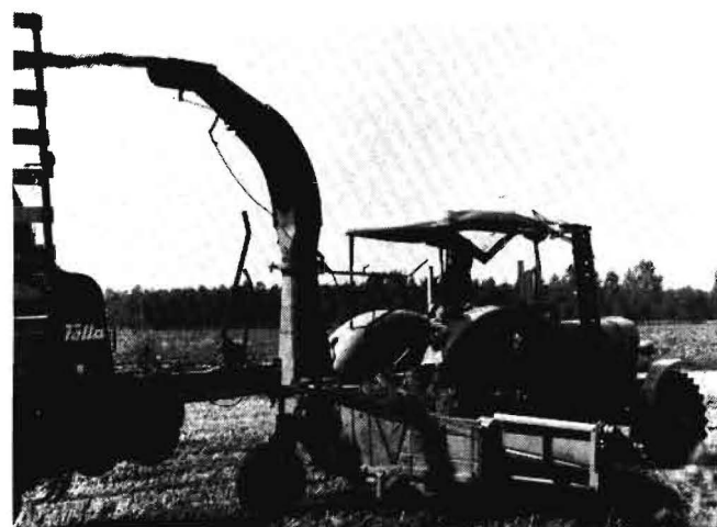
Bild 18: Anbau-Trommel-Feldhäcksler mit Stützrad und Einachser (Ladewagen) beim Häckseln von Futterroggen (hydraul. Ausleger-Aushebung)
