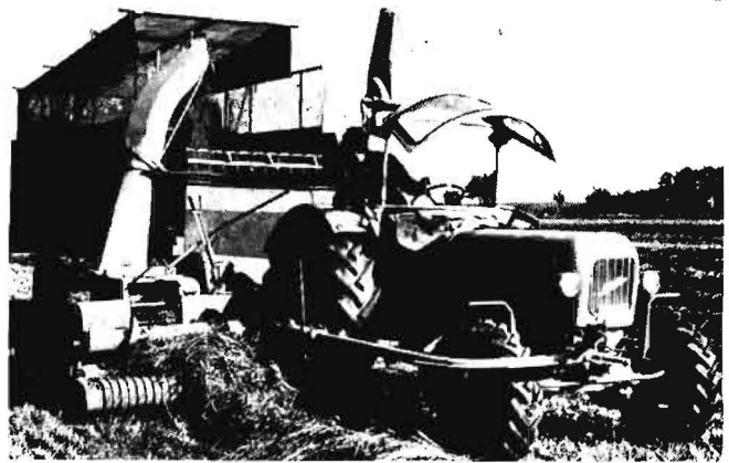
Bild 19: Längsfluß-Trommel-Feldhäcksler im Seitenwagen-Anbau beim Häckseln von Luzerne (Trommeldurchmesser 600 mm, Trommeldrehzahl 1 200 Upm, 6 Messer) Prototyp 1966
