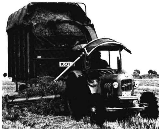
Bild 17: Anbau-Trommel-Feldhäcksler in 3-Punkt-Hydraulik beim Einsatz in Stroh (mit Schneckenverlängerung und Niederhalter)
