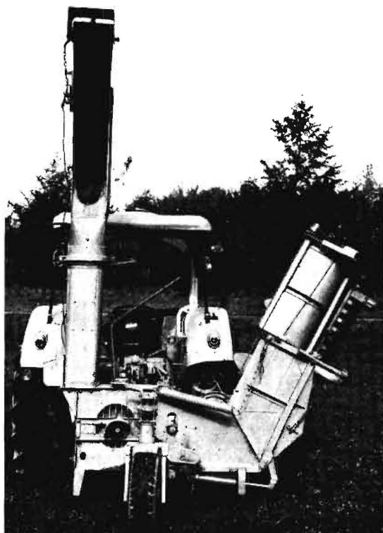
Bild 1 a: Anbau-Trommelfeldhäcksler (Querfluß) mit hydraulisch aufklappbarem Pick-up-Ausleger (Straßenfahrt)
