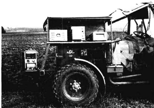
Bild 1: Der Versuchsschlepper mit Tragrahmen für Meßgeräte und Stromaggregat
