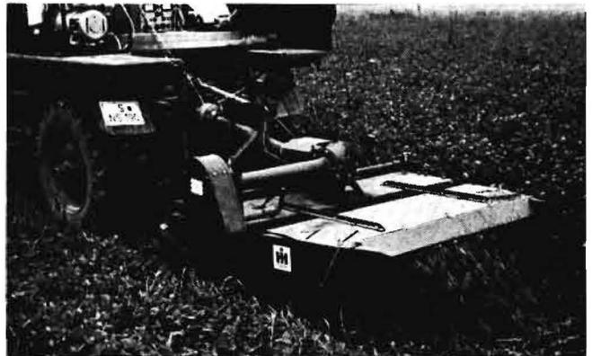
Bild 11: Stengelknickmaschine für Dreipunktanbau am Schlepper mit zwei genutzten Gummilwalzen
