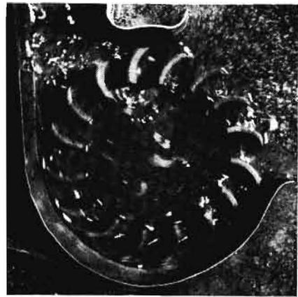
Bild 2: Durchströmung eines Gebläses mit Kreisbogenschaufeln (Modellversuch Flachwasserkanal, Schaufelzahl  $z = 16$ ,  $m = 0,85$ )
