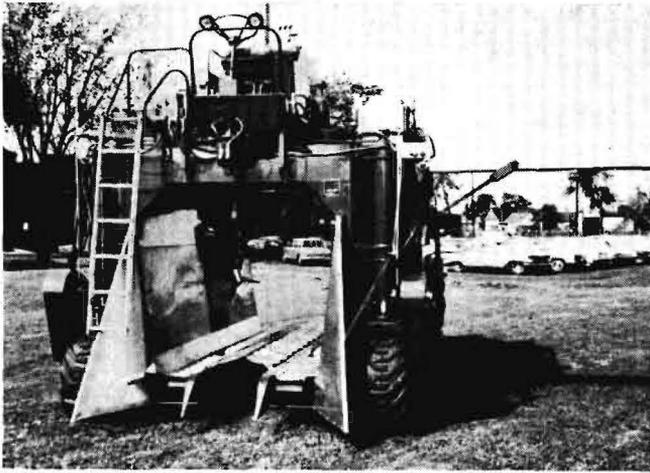
Bild 4: Trauben-Erntemaschine mit Schwingschüttler für das Doppelvorhang-Erziehungssystem
