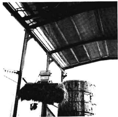
Bild 1: Hallenlaufkran bei der Befüllung eines Hochsilos
