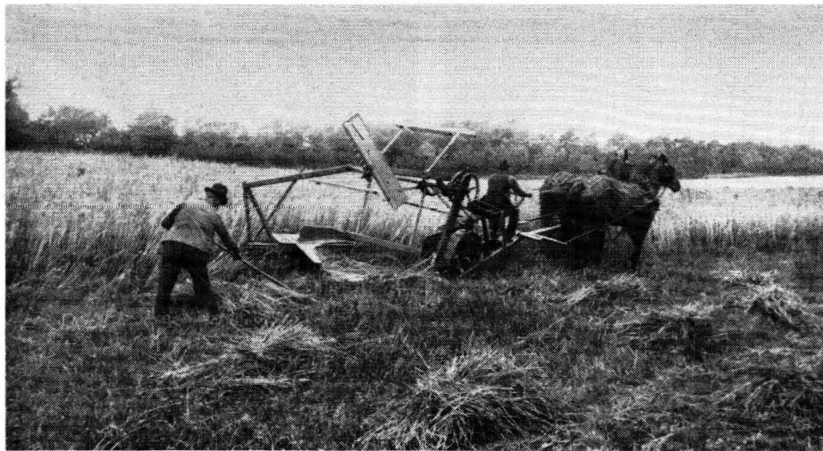
Bild 6. McCormicks erste Mähmaschine mit selbsttätiger mechanischer Garbenablage
