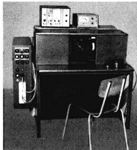
Bohrung sind pneumatische Meßdorne in Verbindung mit AEROPAN-Anzeigegegeräten (Hersteller VEB Maßindustrie Werdau) zu verwenden [3].
